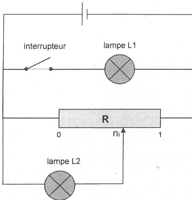
Un circuit électrique est constitué d'une source de tension idéale (donc sans résistance interne), d'un potentiomètre de résistance  $R$ , d'un interrupteur et de deux lampes identiques portant les indications ( $U_L$ ,  $P_L$ ).
