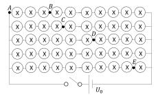
Die Schaltung ist optimal eingerichtet worden. Mit einem einzigen Schalter wird alles hell. Jede Glühlampe hat eine Nennleistung P für eine Nennspannung U. Der Glühfaden jeder Lampe besteht aus Wolfram und hat eine Länge L.
